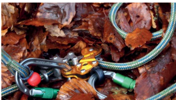
Verschmutzte, nasse oder angefrorene Seile beeinträchtigen die Gerätefunktion des ZigZag scheinbar wenig.
